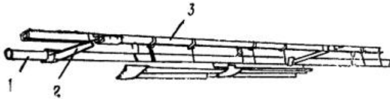
Рис. 43. Шинопровод ШОС67 на кронштейнах, установленных на трубопроводе сжатого воздуха:
