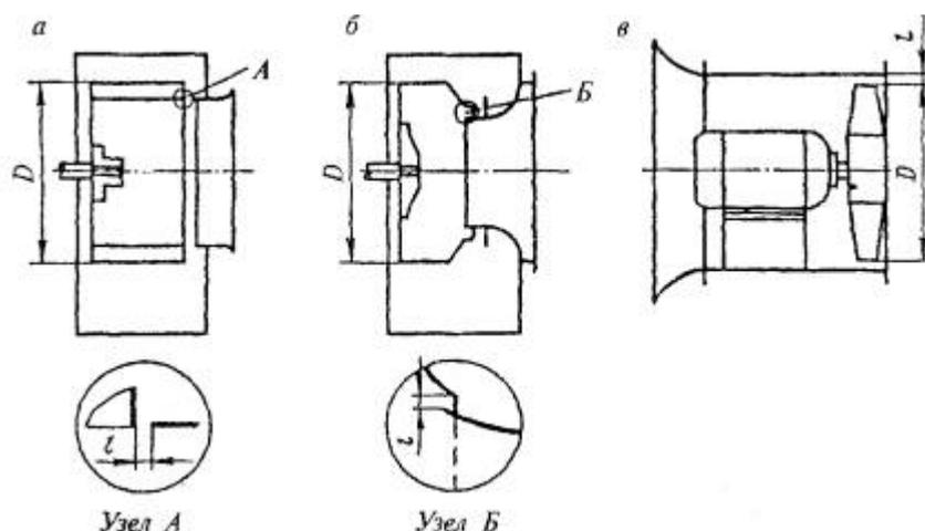
Рис. 2. Схемы зазоров вентиляторов:
