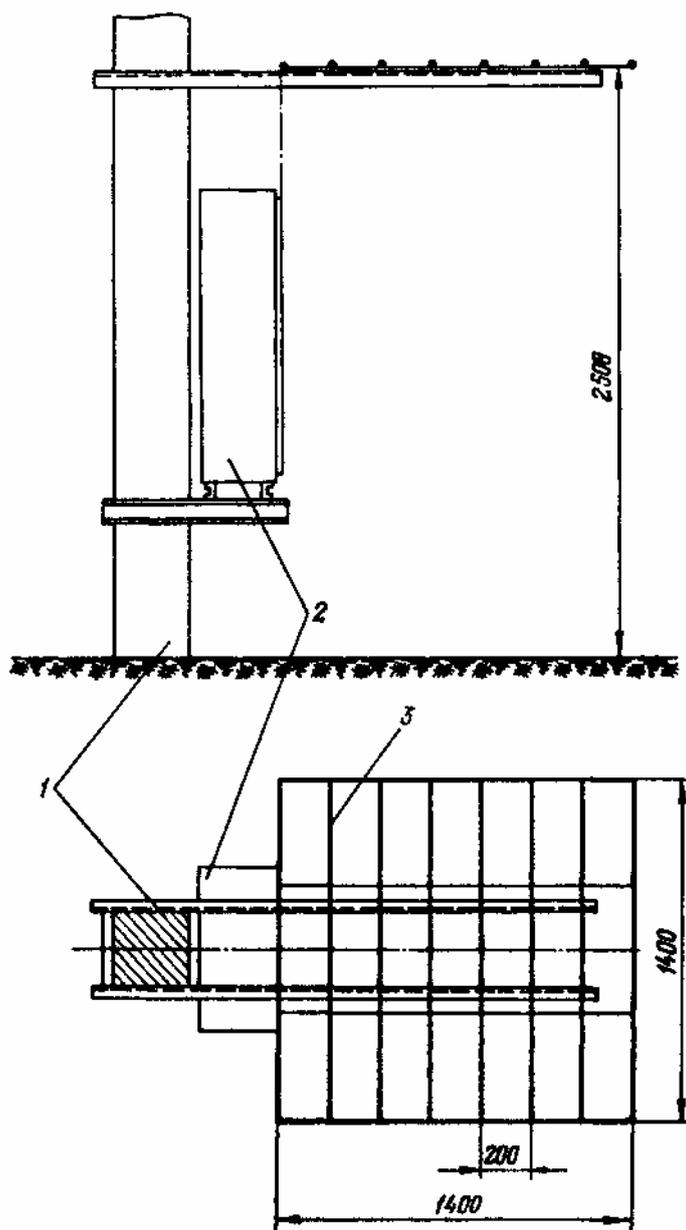
Рис.9. Пример установки экрана козырька из металлических стержней над шкафом вторичных цепей:
