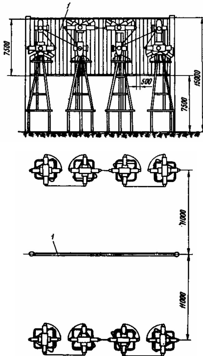
Рис. 2. Пример установки вертикального экрана между ячейками воздушного выключателя ВВБ-750:
