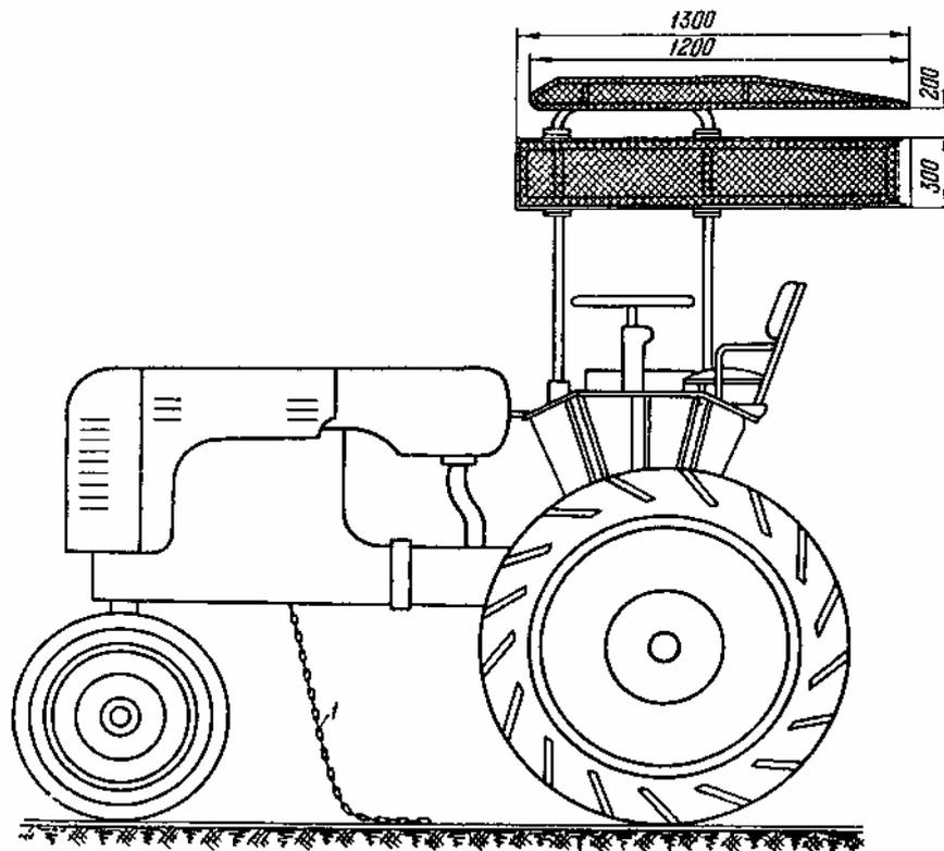
Рис. 10. Экран над рабочим местом водителя трактора:
